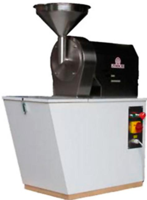
Macchina costruita in acciaio INOX. Tramoggia di immissione zucchero in acciaio inox AISI 304. Filtro del setaccio interno in acciaio inox AISI. il corpo della macchina è montato sopra un cassone di raccolta zucchero in formica bianca lavabile. Trasmissione principale a cinghia. Impianto elettrico a bassa tensione completamente autoestinguente in tutte le sue componenti. Produzione oraria Kg. 35 circa di zucchero a velo. Motore elettrico 2800 giri B3.
