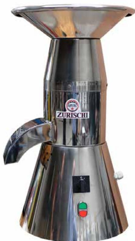
Macchina costruita interamente in acciaio inox AISI 304. Filtro di scarico pane grattugiato in acciaio inox AISI. Trasmissione principale diretta motore/coltelli. Impianto elettrico a bassa tensione completamente autoestinguente, con interruttore generale e pulsanti di marcia ed emergenza. Finecorsa di protezione sul corpo macchina, per l'apertura della macchina stessa. Produzione oraria Kg. 200 circa di pane grattugiato Motore elettrico 2800 giri B5.
