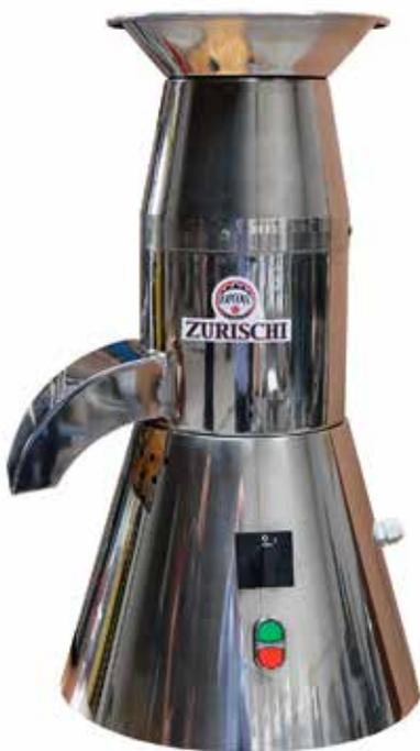
Macchina costruita interamente in acciaio inox AISI 304. Filtro di scarico pane grattugiato in acciaio inox AISI. Trasmissione principale diretta motore/coltelli. Impianto elettrico a bassa tensione completamente autoestinguente, con interruttore generale e pulsanti di marcia ed emergenza. Finecorsa di protezione sul corpo macchina, per l'apertura della macchina stessa. Produzione oraria Kg. 50 circa di pane grattugiato Motore elettrico 2800 giri B5.
