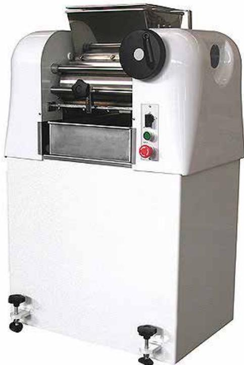
Questa macchina è l'ideale per il Vostro laboratorio di pasticceria. Con ingranaggi in ghisa speciale a bagno d'olio, ingrassatori e un moderno sistema per il fissaggio delle lame raschiatrici la rendono oltre che molto affidabile anche molto veloce e pratica nella pulizia.
