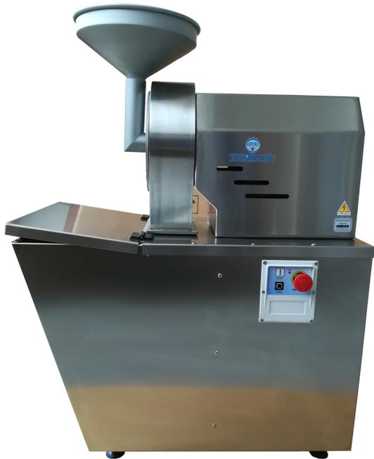
Machina costruita in acciaio inox AISI 304. Tramoggia di immissione zucchero in acciaio inox ISI 304. il corpo macchina è montato su un cassone di raccolta zucchero in acciaio inox AISI 430. Trasmissione principale a cinghia. Impianto elettrico a bassa tensione completamente autoestinguente in tutte le sue componenti. Produzione oraria Kg. 35 circa di zucchero a velo. Motore elettrico 2800 giri B3.
